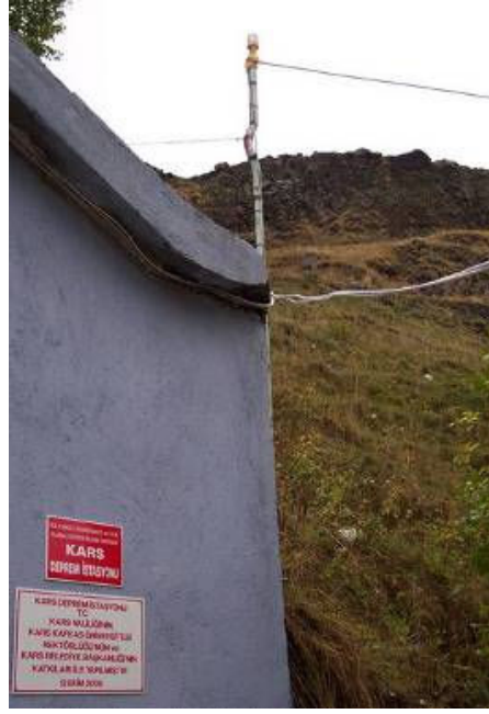
Zaman sinyali almak için GPS anteni çatıya monte edilmiştir.
