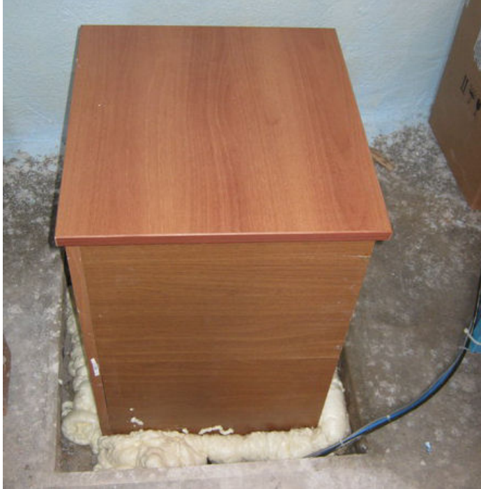
Sismometre, monte edildikten sonra üzerine hazırlanan koruma kapatılmıştır.
