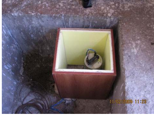
Sismometre'nin montajı ve izolasyon işlemleri
