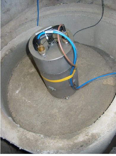
Sismometre, pilyesine yerleřtirildikten sonra baęlantıları ve izolasyonu yapılmıřtır.
