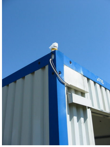
Zaman sinyali almak için GPS anteni çatıya monte edilmiştir.
