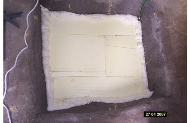
Sismometre yerleştirildikten sonra ısı izolasyonu yapılmıştır.
