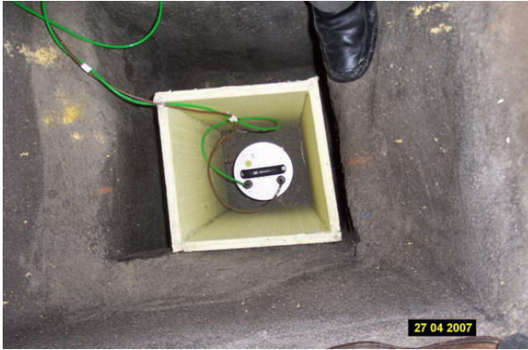
Sismometre yerleştirildikten sonra ısı izolasyonu yapılmıştır.
