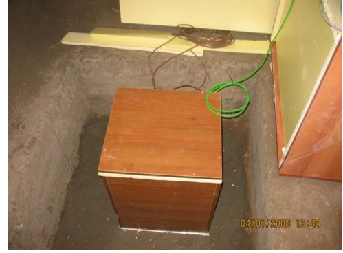
Sismometrenin yerleştirilmesi ve izolasyon işlemi
