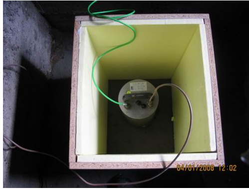
Sismometrenin yerleştirilmesi ve izolasyon işlemi
