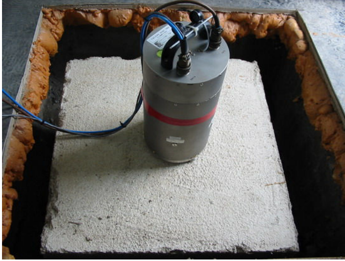
Sismometre, pilyesine yerleřtirildikten sonra baęlantıları ve izolasyonu yapılmıřtır.
