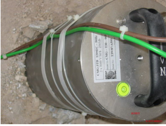
Sismometre cam elyafı ve strafor ile izole edilmiştir.
