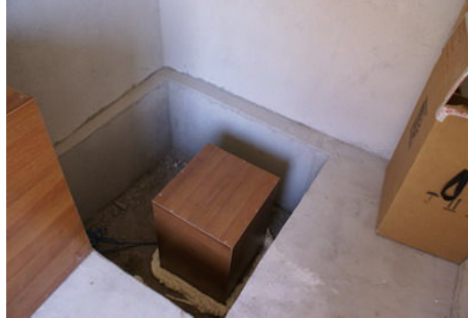
Sismometre, yerleřtirildikten sonra ısı izolasyonu yapılarak, ısı deęiřimlerinden etkilenmemesi saęlanmıřtır.
