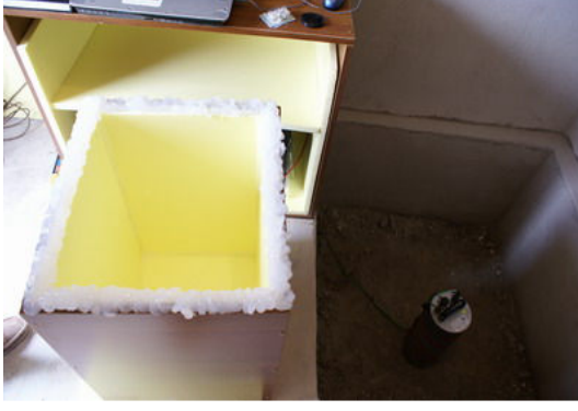
Sismometre, yerleřtirildikten sonra ısı izolasyonu yapılarak, ısı deęiřimlerinden etkilenmemesi saęlanmıřtır.
