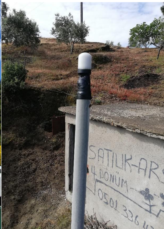
İstasyonun kapı kilidi değiştirildi. Ek olarak 75 watt güneş paneli eklendi. Güneş paneli regülatörü değiştirilerek oksitlenen bağlantı kabloları yenilendi. Gps anten değiştirildi.
