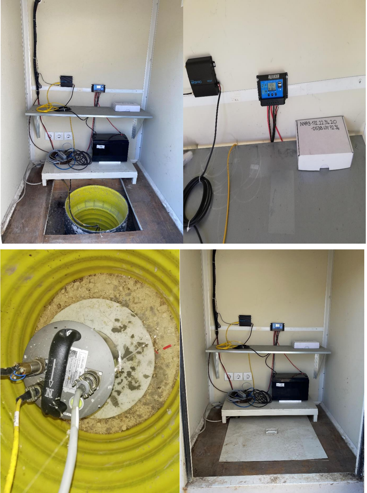
Akü deęiřtirildi. Sismometre montajı , terazi , yn ayarı yapılarak montajı yapıldı. Cloudgate modem lie Turkcell hat kullanılarak sismometre verisi Kandilli Rasathanesi ve Deprem Arařtırma Enstits'ne veri akıřı saęlandı.
