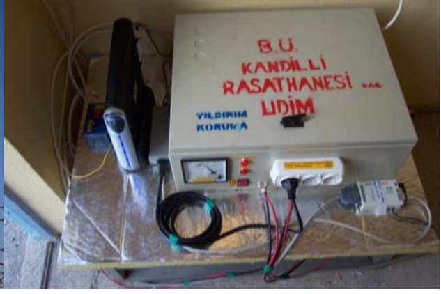
Koruma Ünitesi ve sinyali uyduya gönderen çanak, Uydu Modem-Aküler ve GPS bağlantılarından bir görünüm
