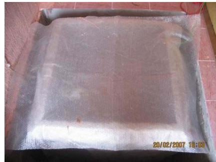
Sismometrenin yerleştirildikten sonra izolasyonunun yapılması
