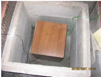
Sismometrenin yerleştirildikten sonra izolasyonunun yapılması
