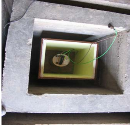
Sismometrenin yerleştirilmesi ve izolasyon işlemi
