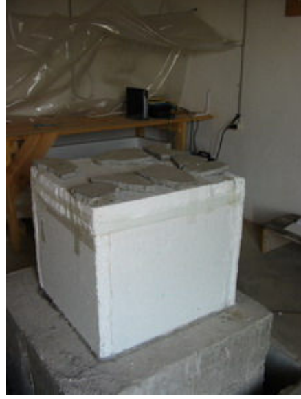
Sismometre strafor ile izole edilmiştir.
