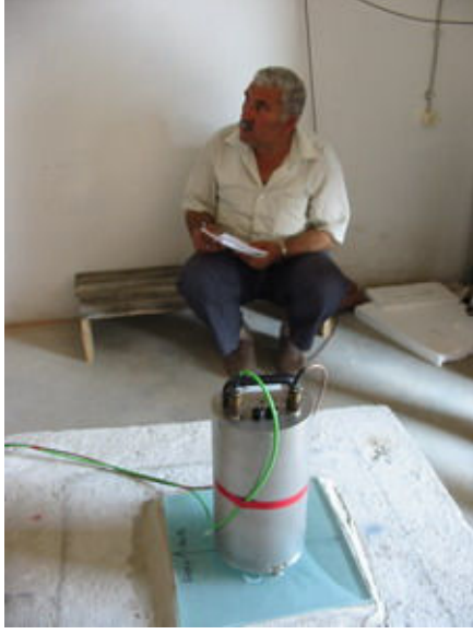
Sismometre strafor ile izole edilmiştir.
