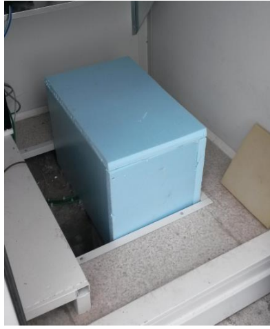
Sismometreler montaj yapılarak izolasyon yapıldı.
