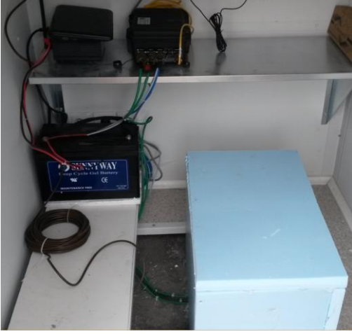
Sismometreler montaj yapılarak izolasyon yapıldı.
