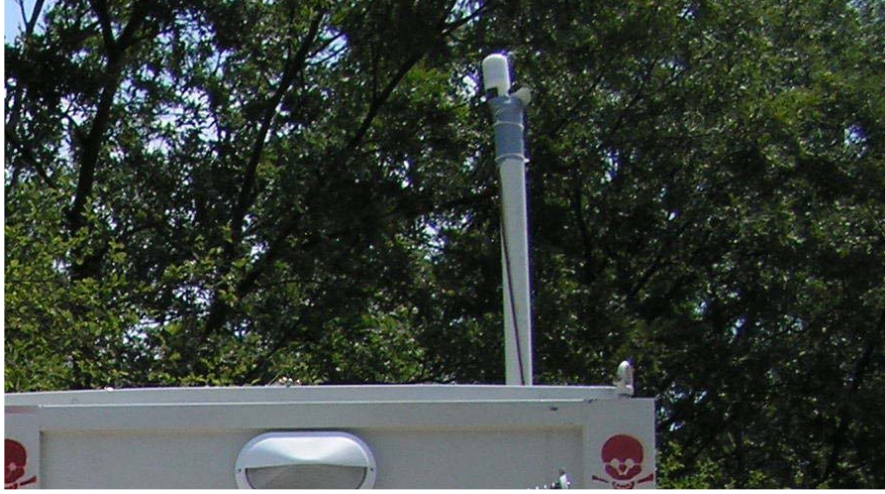
Zaman sinyali almak için GPS anteni çatıya monte edilmiştir.
