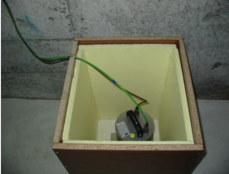
Sismometre yerleřtirildikten sonra ısı izolasyonu yapılmıřtır.
