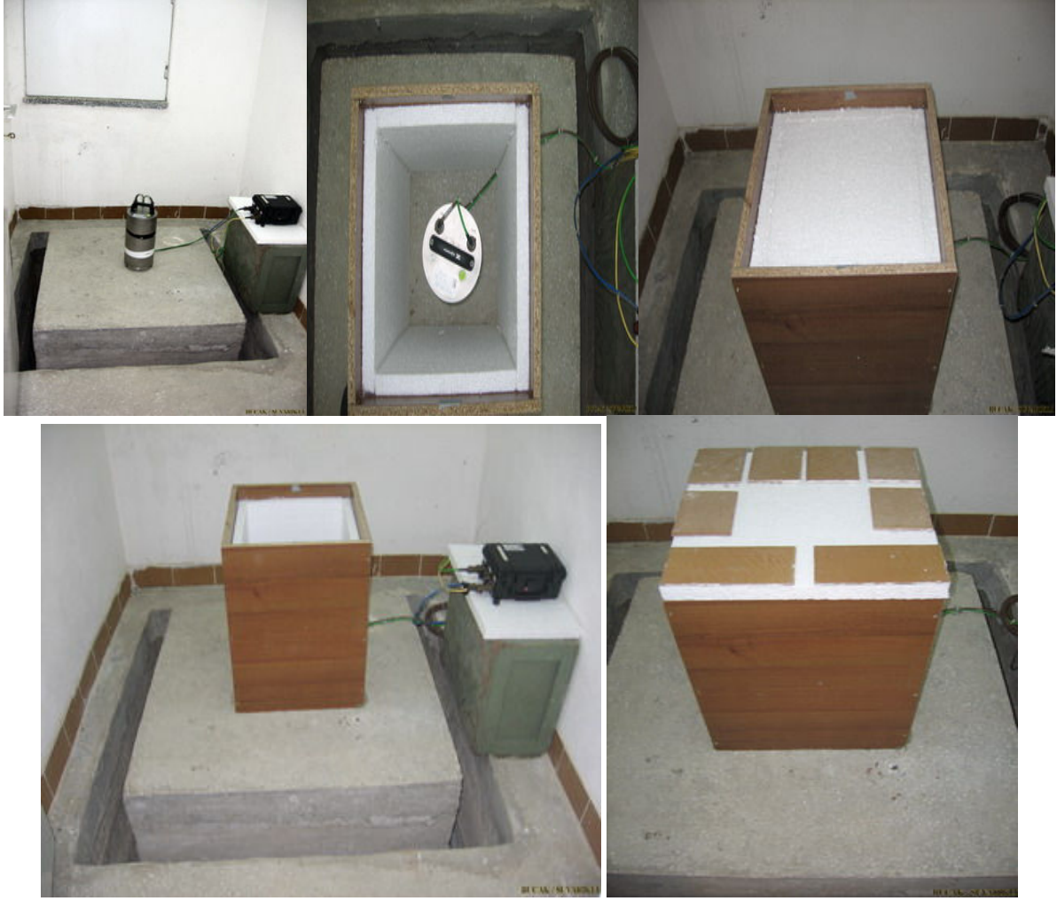
Sismometre, yerleřtirildikten sonra ısı izolasyonu yapılarak, ısı deęiřimlerinden etkilenmemesi saęlanmıřtır.
