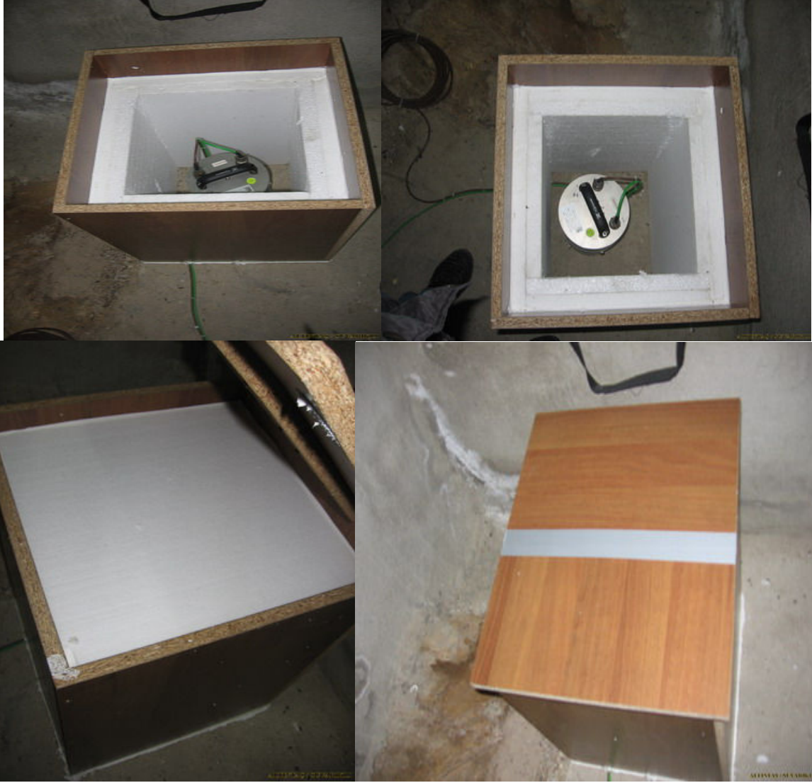
Sismometre, yerleřtirildikten sonra ısı izolasyonu yapılarak, ısı deęiřimlerinden etkilenmemesi saęlanmıřtır.
